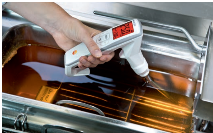
Fig. 10: Mätning av TPM-värde i fritureolja med testo 270
