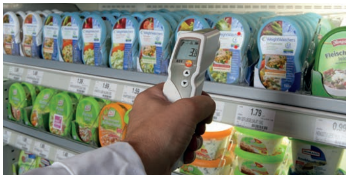
Fig. 5: Infraröd mätning av ytemperatur på livsmedel
