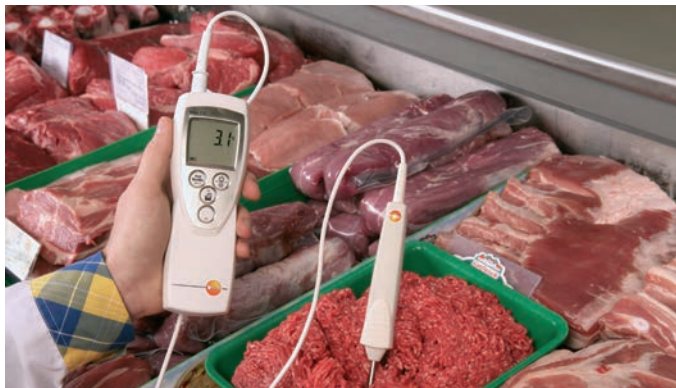
Fig. 17: Användning av testo 112 med insticksgivare
